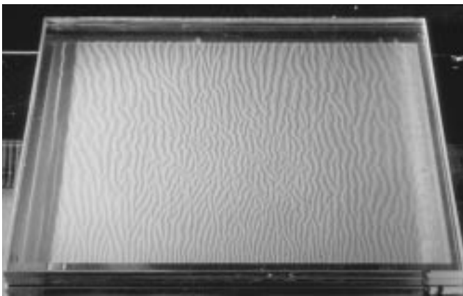
Abb. 3 – Entwicklung der Verwellung eines Pergaminpapiers, auf das Glasplatten gelegt wurden (Gesamtdruck 5 \text{ g/cm}^2 ): a) zu Beginn des Experiments ( t=0 ), b) bei t=48 Stunden und c) bei t=2 Wochen.
